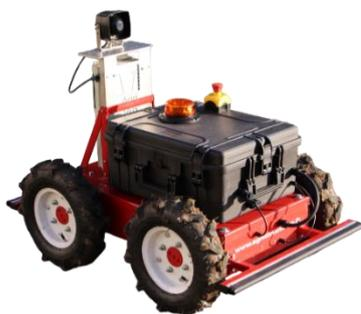
Le RovTrac® est un robot terrestre autonome qui repousse les oiseaux. Il se déplace grâce à un système GNSS et éloigne les oiseaux et le gibier des zones cultivées. Cette dernière innovation d'AgriProTech peut protéger des surfaces allant jusqu'à 30 hectares et sera disponible dans le courant de l'année 2025.
